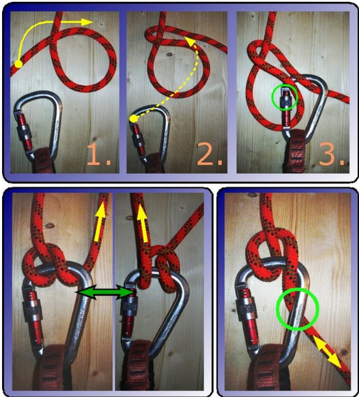
Erstellung eines Halbmastwurf, Umschlagen des Halbmastwurfs, Seilführung und Verschlusshülse
