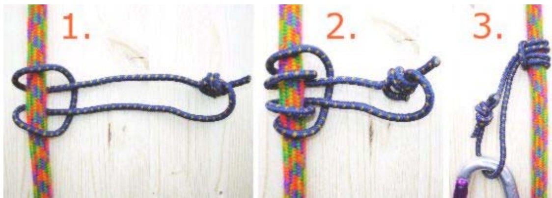
Knüpfen eines Prusikknotens
